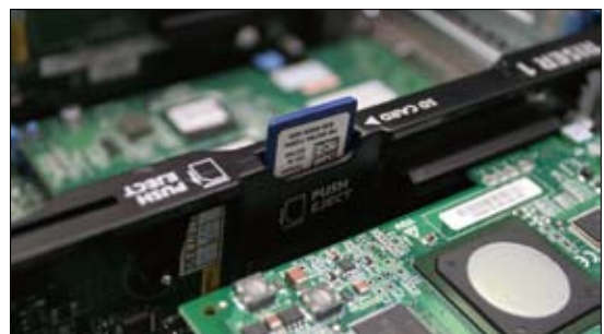
圖4 Dell PE R805內建SD卡擴充槽可存放ESXi。
