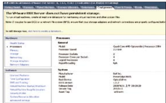
圖14 在Configuration頁籤的部分點選[create a datastore..]以切割硬碟資源。
