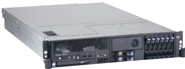
圖19 IBM x3650可以安裝最多8個SAS硬碟，成為企業多功能應用伺服器之選擇。
